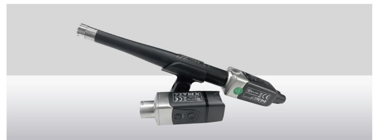
整套无线测量传声器在出厂时，用静电激励器法根据 IEC61049 标准进行校准，每一套传声器都有频响和灵敏度的校准报告，频响达到 IEC 61672 一级的要求。
