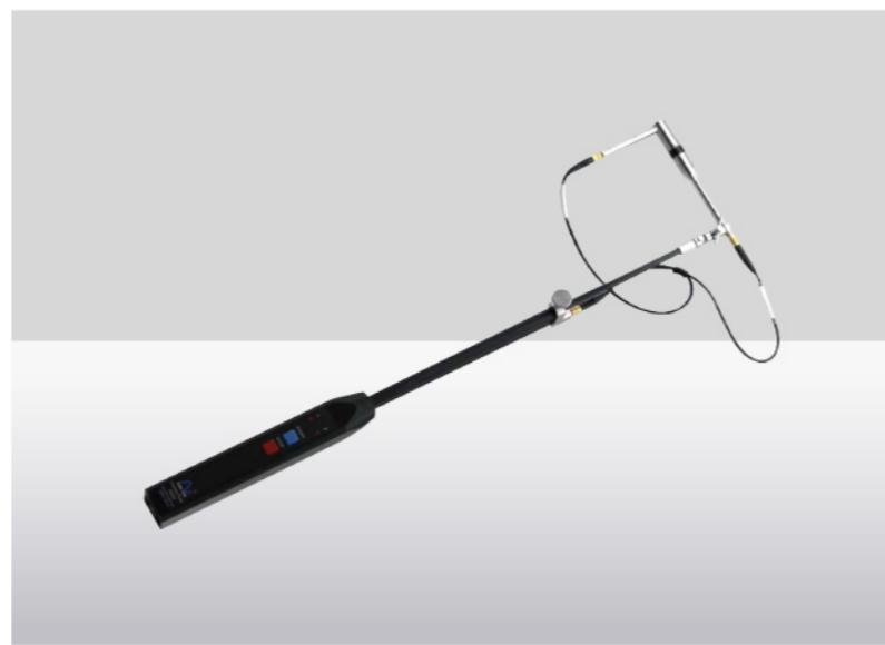
SI522 使用结实耐用的框架把两个 ICCP 前置放大器以及相位匹配的传声器连接在一起，构成面对面的结构，两个传声器之间是一个塑料间隔。配备 8.5mm、12mm 以及 50mm 三种不同规格的塑料间隔体。
