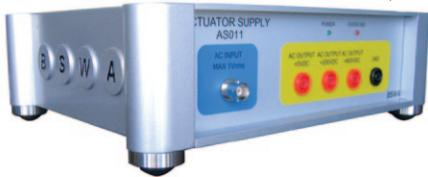
声望静电激励器供电器AS011将输入信号放大30dB后分别加载到200V或800V的直流电压上，它有三个输出接口：AC output, AC +200VDC output 和 AC +800VDC output。直流电压为200V的信号可以驱动传声器产生高频信号声源，直流电压为800V的信号可以驱动静电激励器来测量传声器的频率响应。
